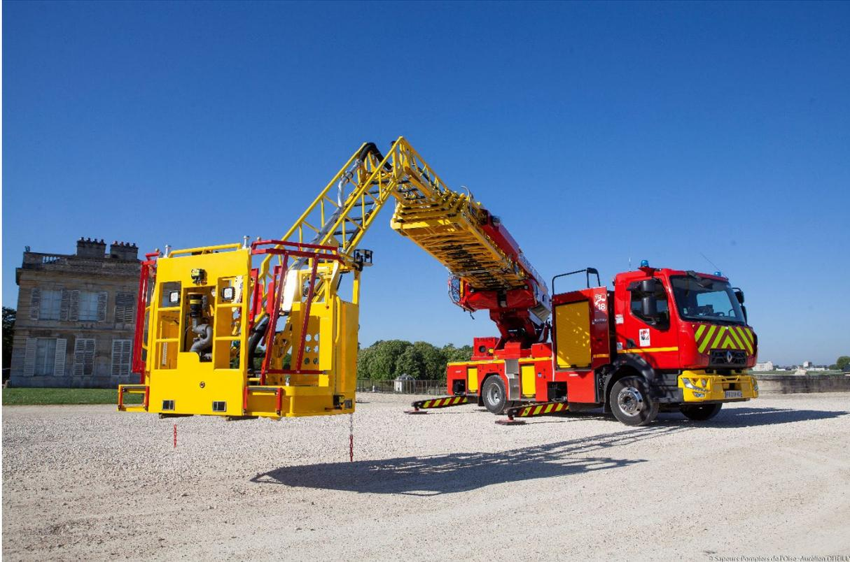
Moyen élévateur aérien d'appui compact pour les opérations de sauvetage, de lutte contre l'incendie et de protection de biens, permettant d'intervenir dans les espaces et îlots contraints. Il permet également un accès aisé aux cours intérieures des habitations et châteaux et aux fenêtres de toits, combles aménagés et versant d'une toiture opposée.
