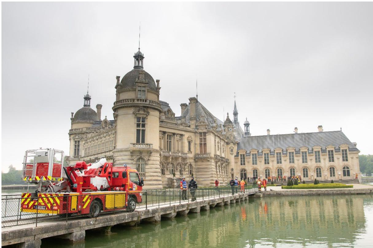
Moyen élévateur aérien d'appui compact pour les opérations de sauvetage, de lutte contre l'incendie et de protection de biens, permettant d'intervenir dans les espaces et îlots contraints et d'emprunter des ponts de tonnage limité. Il permet également un accès aisé aux cours intérieures des habitations et châteaux.
