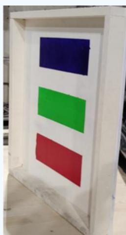
Tableau type avant essai-cadre en silicate de calcium incombustible (3 répliques identiques référencés tableau 1, tableau 2 et tableau 3)
