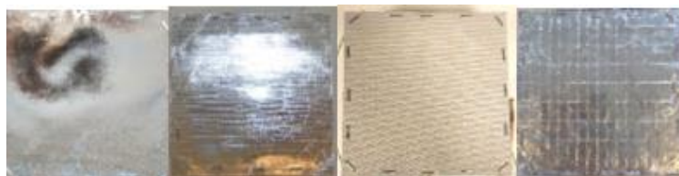
Figure 4 : Faces exposées après essai des outils de protection de la gauche vers la droite : Op1t/c ; op2t/c ; op3t et op3c
