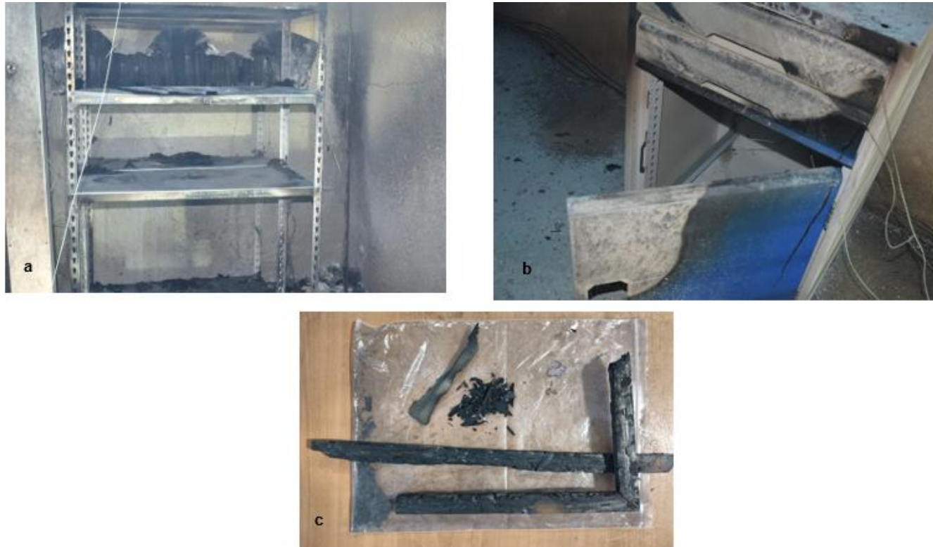
Figure 18 : Eléments de la réserve après essai feu sans extinction (a=étagère, b=armoire métallique, c= châssis résiduels des tableaux)
